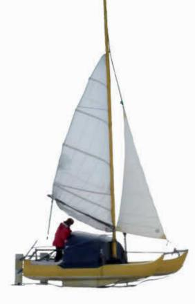
Le deuxième prototype est le premier bateau de la lignée avec des coques gonflables en kevlar, des ailerons «porte-ski», une poutre-nacelle habitable et enfin un mât auto-porteur.
